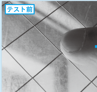
写真2 テスト研磨の結果確認。劣化傷が顕著だったのが、研磨後は透明度が回復 していることが確認できる
